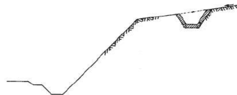
Mise en place d'une cunette béton en tête de talus. Source : FONDASOL
